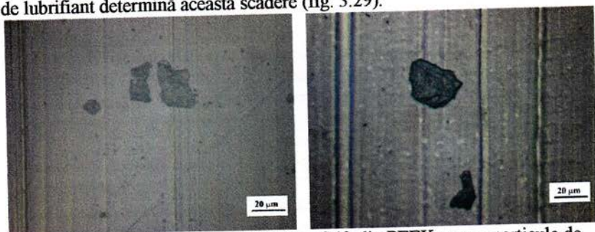
Fig. 3.28. Imagini la microscopul optic. Știft din PEEK pur cu particule de uzură (stânga); știft din PEEK ELS Nano cu particule de uzură (dreapta) v=1,5\text{ m/s} , p=1\text{ MPa}
