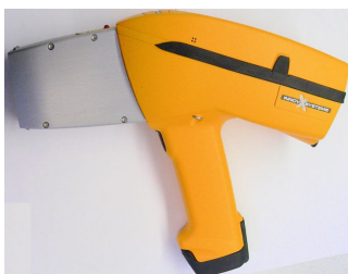
Fig. 3.10. Aparat mobil cu fluorescență cu raze X (InnovX - Systems) [117].
