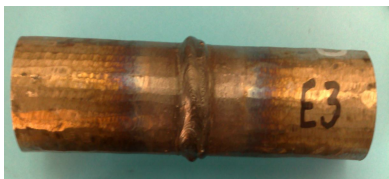
Fig. 5.88. Proba sudată cap la cap E3, netratată termic [117].
