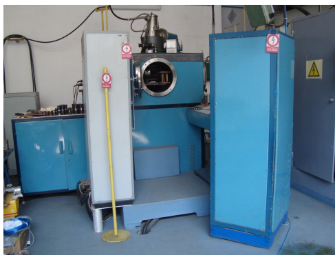
Fig. 3.6. Instalația de sudare cu fascicul de electroni [117].
