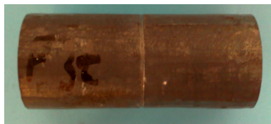
Fig. 5.115. Proba sudată cap la cap F3T, termic [117].
