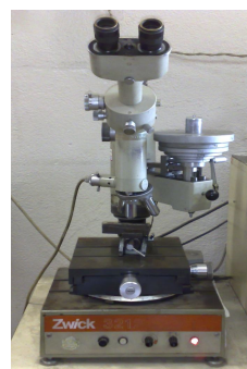
Fig. 3.14. Durimetru Vickers HV tip ZWICK 3212 [117].
