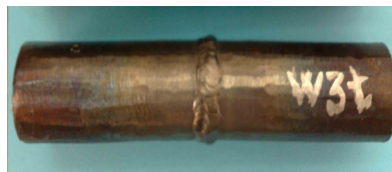
Fig. 5.102. Proba sudată cap la cap W3T, tratată termic [117].
