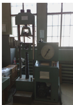
Fig. 3.12. Mașina universală de 100 kN tip ZD10 [117].
