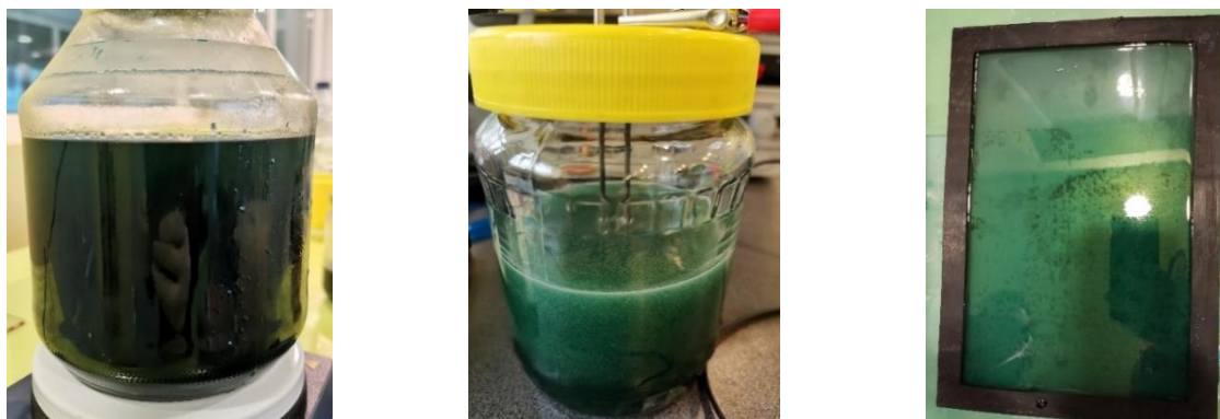
Fig.3.2. Amestecul pentru formarea probelor cu cloruri metalice B, electroliză cu electrozi de grafit, matriță tip foi de sticlă și epruvetă (de la stânga la dreapta)
