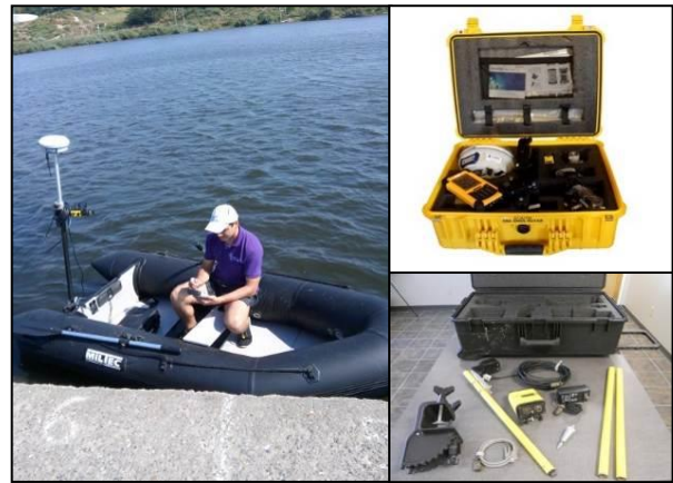
Figura 3.30. Instrumentul SonarMite utilizat cuplat cu GPS South S82-V
