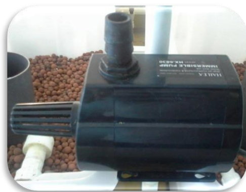
Fig. 2.7. Pompă submersibilă tip HAILEA HX 6830 folosită pentru alimentarea unităților acvaponice (foto. original)
