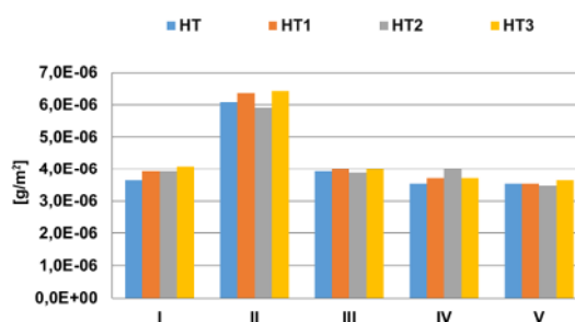
Figura 5.9. Absorbția pe suprafață pentru materialele epoxidice modificate cu ferite.
