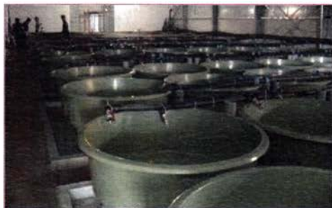
Foto 25. Bazine fibră sticlă cu capacitatea de 400 l, amplasate în hala izolată termic,
