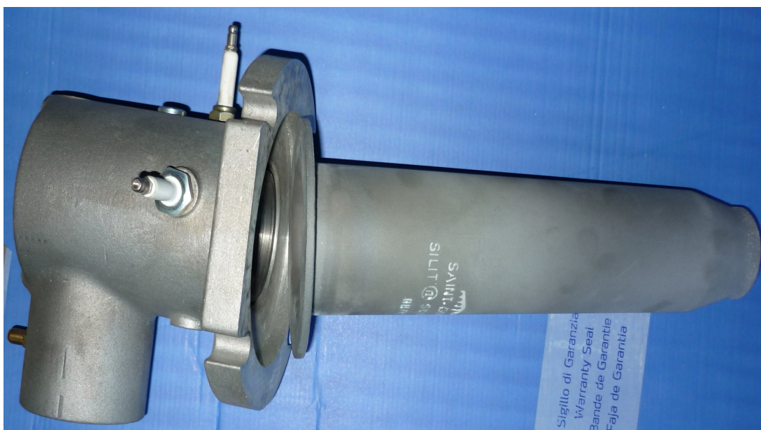
Figura 3.3. Arzător de gaze tip GBS cu tub ceramic radiant tip Silit SKS [84].
