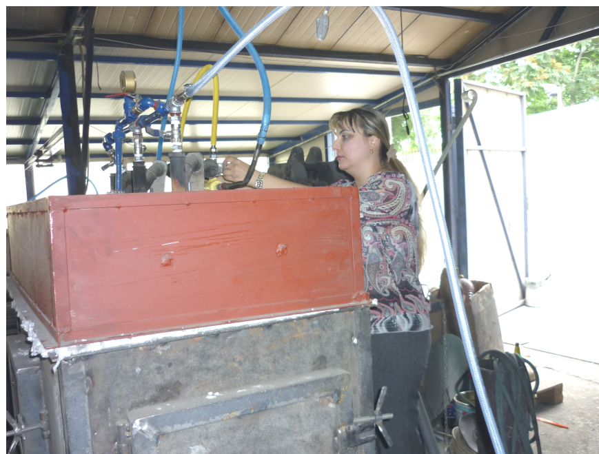
Figura 5.2. Testarea cuptorului cu 3 arzătoare de gaze mai mici.
