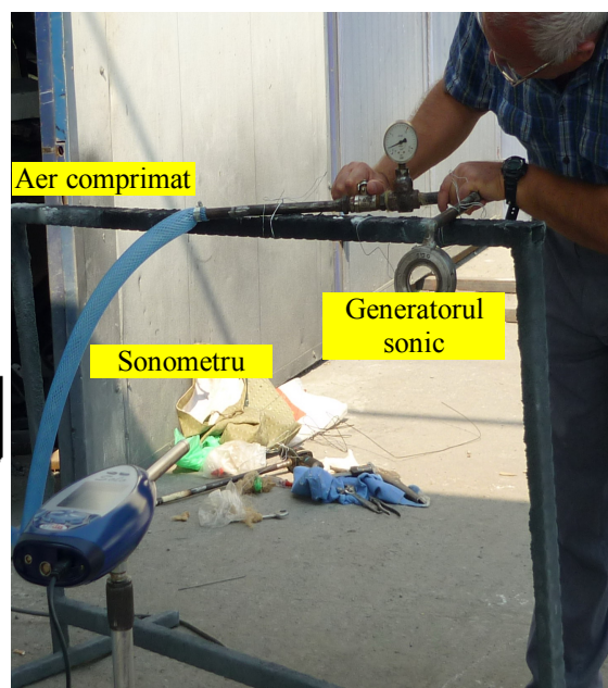
Figura 4.4. Schema efectuării măsurărilor la diferite unghiuri de emisie acustică a generatorului.
