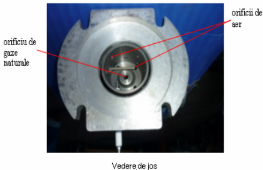
Figura 3.7. Realizarea practică a arzătorului GBS [72].
