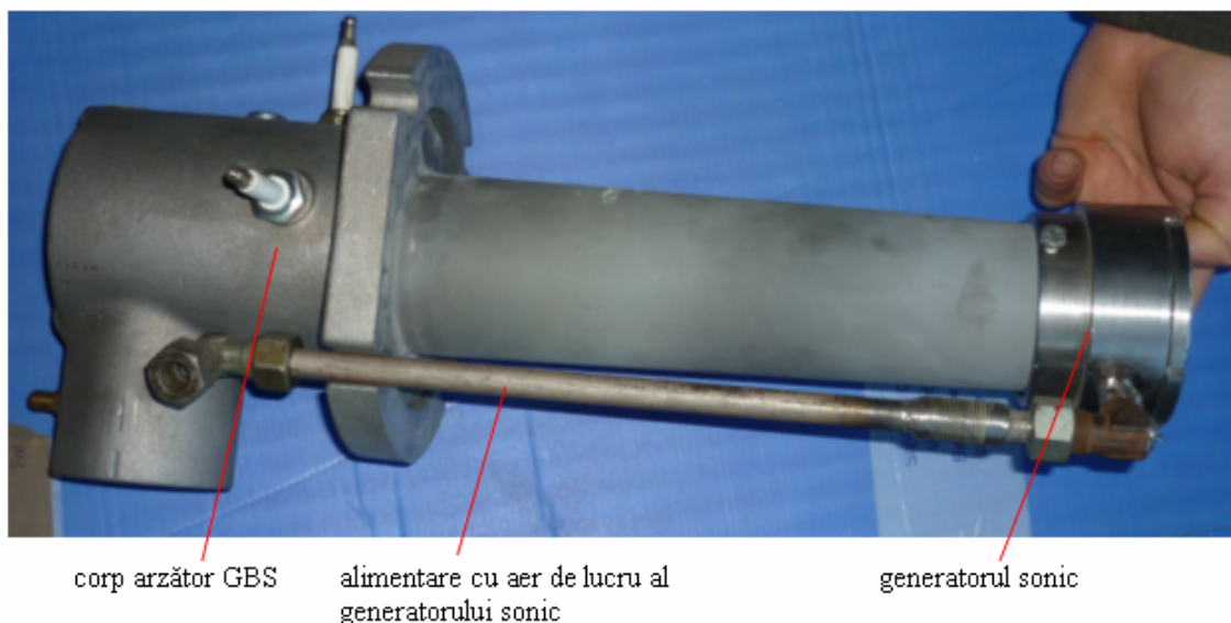
Figura 3.8. Realizarea practică a arzătorului tip GBS cu gaze naturale prevăzut cu generator sonic gazodinamic radial.
