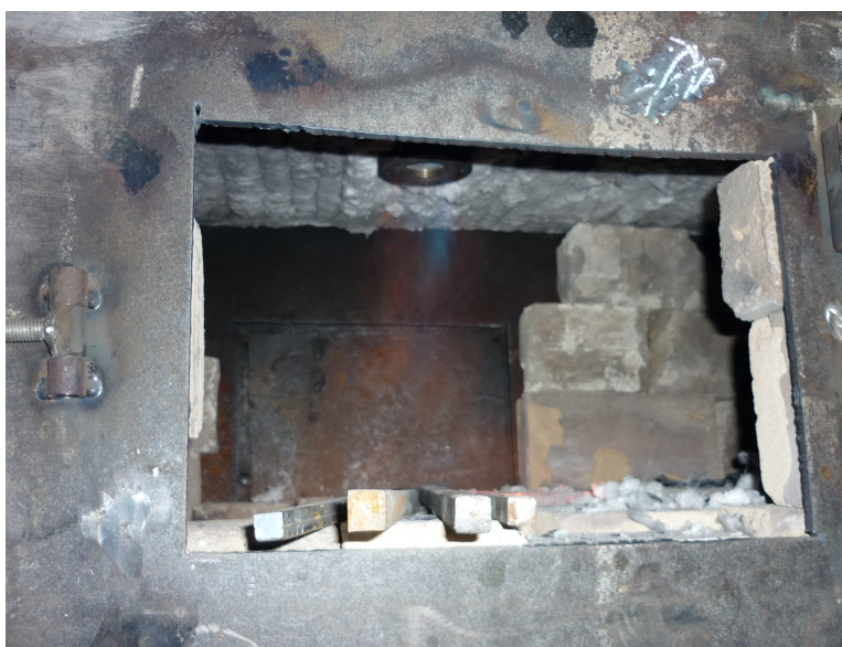
Figura 5.17. Funcționarea arzătorului cu generatorul sonic la presiunea aerului de alimentare de 0,2 MPa și fanta generatorului de 0,25 mm.
