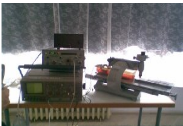
Fig. 12 Instalația folosită la determinarea parametrilor acustici
