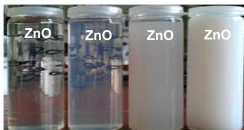
Fig. 3.1 Dispersii de nanoparticule de ZnO obținute din soluții cu concentrații diferite de precursor a) 0,025M; b) 0,035M; c) 0,045M și d) 0,11M.
