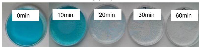
Fig. 4.3 Fotodegradarea soluției de MB în prezența nanoparticulelor de ZnO cu dimensiunea de 55nm pentru intervale diferite de timp (0-60min); imagini ale probelor de ZnO pentru diferite intervale de timp
