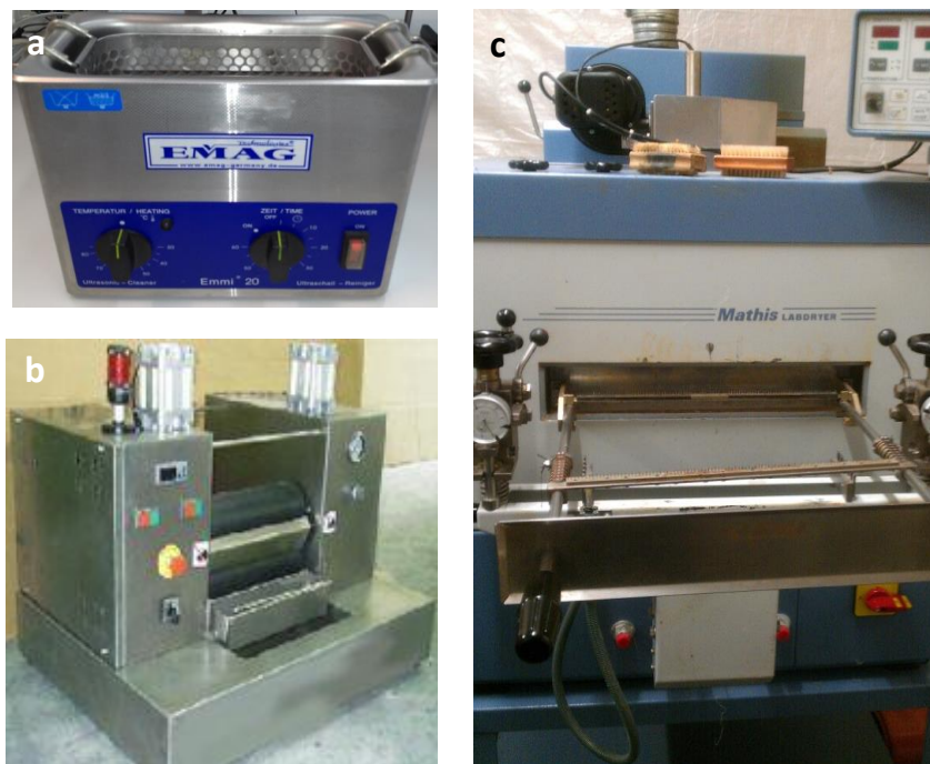
Fig. 2.2 Dipozitive utilizate pentru depunerea nanoparticulelor pe materiale textil: Baia cu ultrasunete Emmi 20 (a), Fulard tip Mathis, Switzerland (b) și Cuptor de tratament termic pentru textile-Mathis (c).
