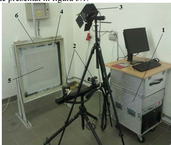
Fig. 5.1 – Stand pentru măsurarea deformațiilor plăcilor din PAFS solicitate la impact.
