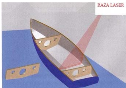
Fig. 1.10 – Scanarea locului de dispunere a reperului de înlocuit.
