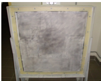
Fig. 5.5 - Prinderea planșelor plane cu/fără osatură
