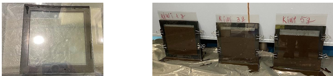
Fig. 2. Matrițe din foi de sticlă și cauciuc
