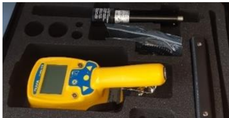
Figura 2.31. Aparatul radiometric CoMo 170 Nuvia Instruments – proprietate SetCar S.A. Brăila
