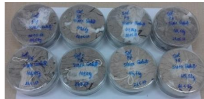
Figura 2.19. Ambalarea în recipiente de tip sarpagan a probelor de sol prelevate din jurul combinatului metalurgic Liberty Galați, în vederea efectuării analizei GRS
