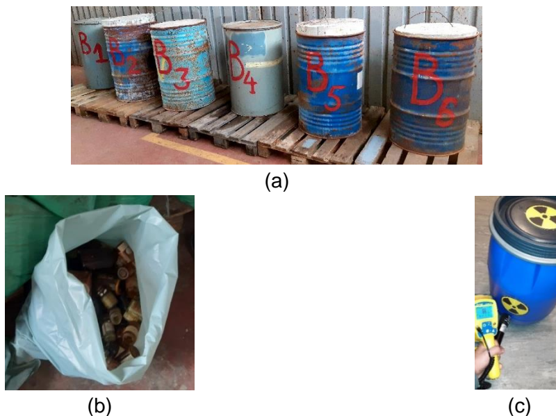
Figura 2.5. Modul de ambalare al deșeurilor solide radioactive necunoscute (sursă: adaptare după [Sloată și Ene, 2021b])
