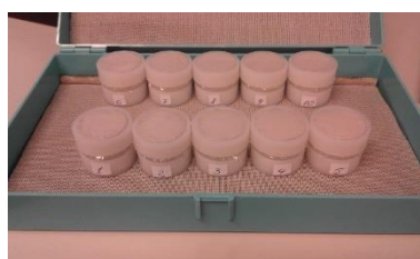
Figura 2.14. Prepararea și încapsularea probelor de deșeu solid rezultat din procese de decapare a pieselor metalice (sursă: adaptare după [Ene ș.a., 2021b])
