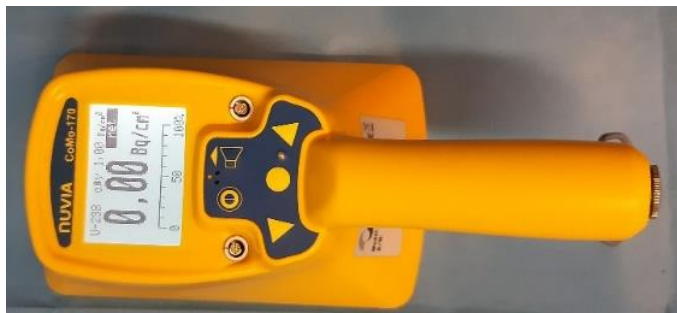
Figura 2.32. Contaminometrul CoMo 170 Nuvia Instruments – proprietate SetCar S.A. Brăila (sursă: adaptare după [Sloată și Ene, 2021a, b])
