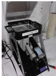
Figura 2.22. Spectrometrul ED-XRF, X-MET 5000, Oxford Instruments (sursă: adaptare după [Ene și Sloată, 2017], [Sloată și Ene, 2017a, b])
