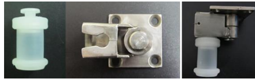
Figura 2.18. Recipientul din teflon utilizat pentru ambalarea probelor și mecanismul de manipulare al acestuia (sursă: adaptare după [Pavlov ș.a., 2016])
