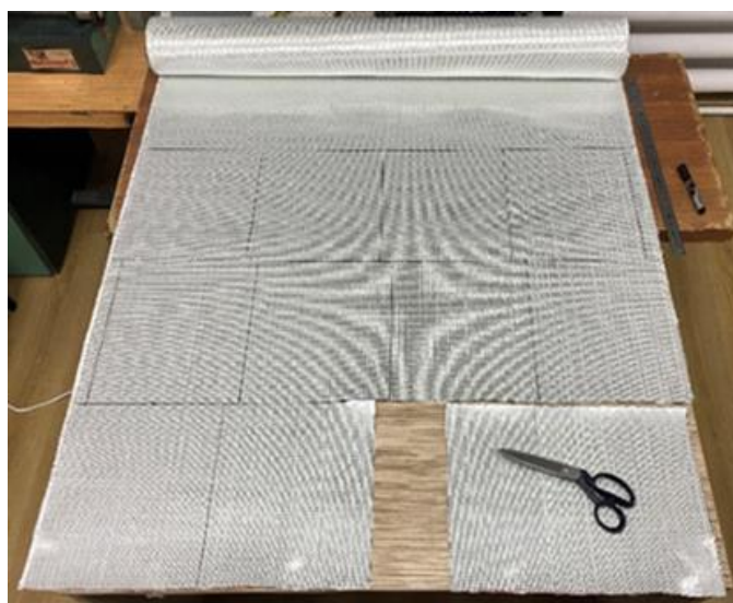
Fig. 4.3. Confecționarea foilor de țesătură quadriaxială
