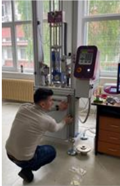
Fig. 4.7. Mașina de testat la impact de viteză mică Instron CEAST 9340 - [57] în timpul testelor
