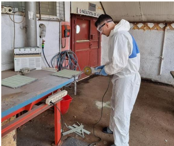
Fig. 4.6. Tăierea eşantioanelor din panoul de material compozit
