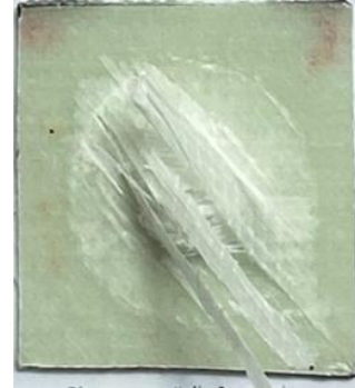
Fig. 3.14. Imagini ale plăcilor testate în aceleași condiții ca și cazurile simulate ( v_3=4 m/s, plăci de 60 mm×60 mm)
