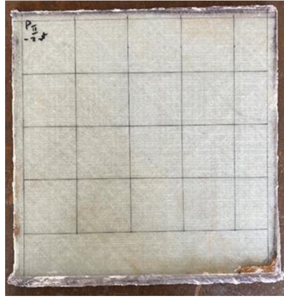
Fig. 4.5. Trasarea eşantioanelor de testat pe panourile compozite formate
