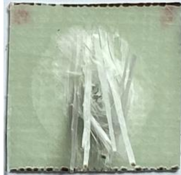
Fig. 3.14. Imagini ale plăcilor testate în aceleași condiții ca și cazurile simulate ( v_3=4 m/s, plăci de 60 mm×60 mm)
