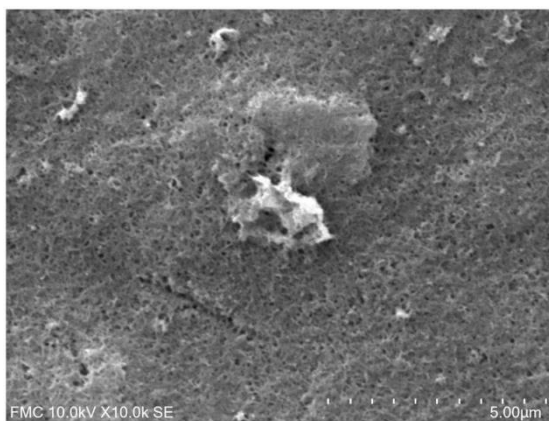
Figura VIII.2. Imagine SEM a suprafeței biosenzorului CNT-GNP-Lac/SPCE
