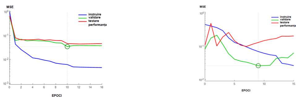
Figura 3.12 Cea mai bună performanță a modelului ANN în funcție de variația valorilor MSE conform numărului de epoci (iterații). (a) V1; (b) V3.
